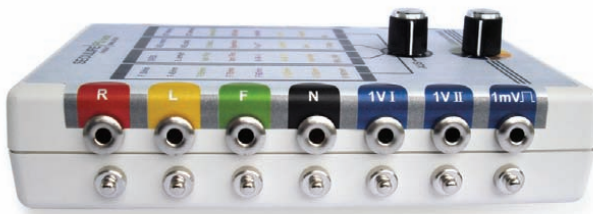
Abbildung 6-1: Vorverstärktes EKG und 1mV Rechtecksignal
