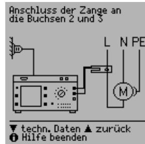
Mit einem an die Buchsen 2 und 3 angeschlossenen Zangen-Strom-/Spannungswandler z. B. WZ12C können in zwei Messbereichen (1 mA ... 10 A ~, 1 A ... 100 A~) Wechselströme gemessen werden.
