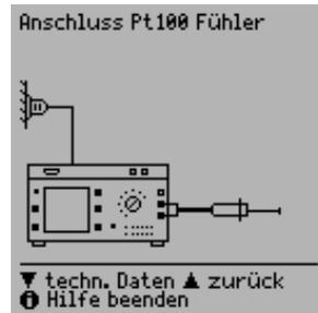
Mit einem Pt100- oder Pt1000-Fühler (Grundeinstellung), der an die Buchsen 1 und 2 anzuschließen ist, können Temperaturen im Bereich – 200 °C ... +850 °C gemessen werden.
