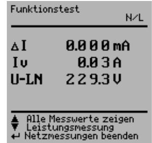
Mit der Taste (14) kann die Prüfdose spannungsfrei geschaltet oder mit der Taste (12) der Funktionstest beendet werden.
